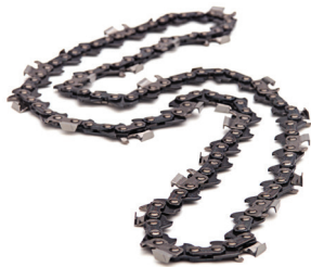
PILOVÝ ŘETĚZ H38 PIXEL 3/8" MINI / 1,1 MM / 45 ČL. 581 80 79-45
